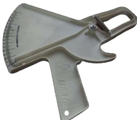
*Nota.* Tamaño: 27.5 x 26 x 6 cm. Rango de 80mm, incrementos de 1mm, precisión +/- 1 mm
